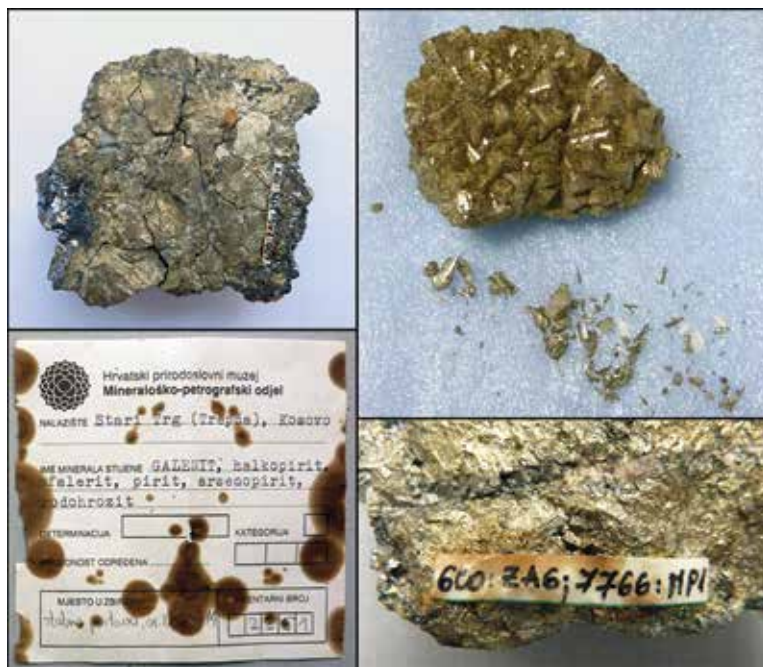
Slika 2. Proces oksidacije uzrokuje pucanje i raspadanje te u konačnici dovode i do potpunog uništenja uzorka. Pritom često stradava i papirnata dokumentacija
