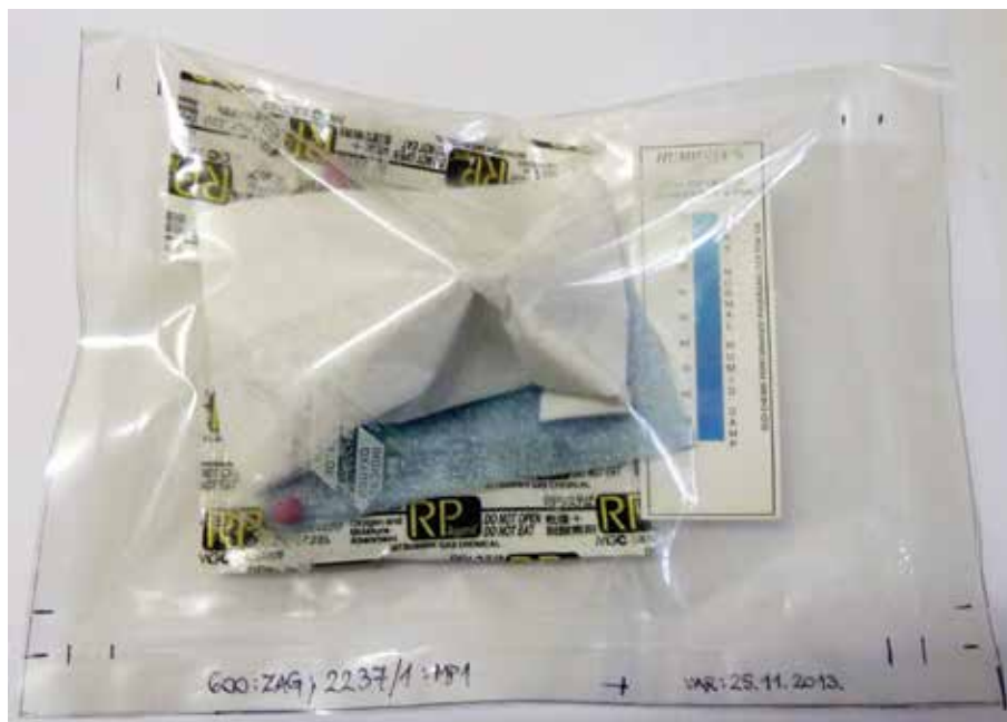
Slika 3. Uzorak sulfida zamotan u beskiselinski papir i zaštićen prozирnom, nepropusnom folijom spremljen je zajedno s apsorberima vlage, kisika i korozivnih plinova te indikatorima razine kisika i vlažnosti za dugotrajno čuvanje
